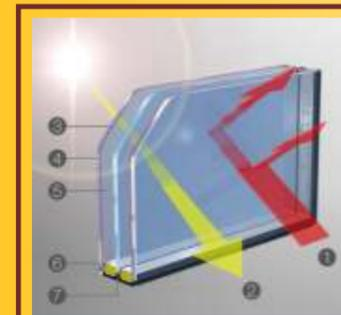
**Aufbau u. Funktion einer Wärmeschutzverglasung:**
